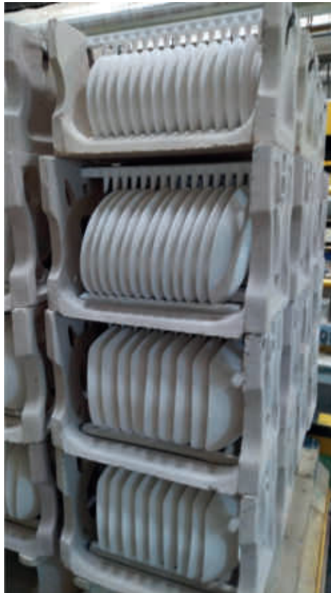
Figura 3. Uso de estuches y perno-peines para la quema de bizcochos.
