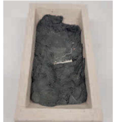
Probeta de CBC 50 RAL luego del ensayo a altas temperaturas.
