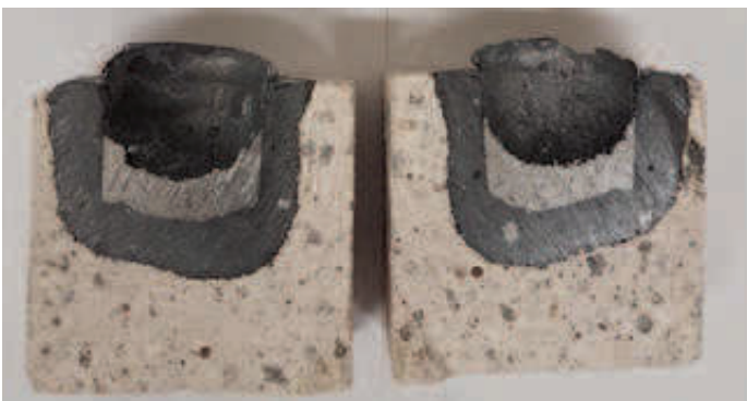
Fotografía concreto refractario CBC 50 luego de la prueba de ataque.
