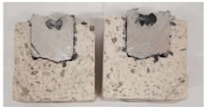
Fotografía concreto refractario CBC 50 RAL luego de la prueba de ataque.
