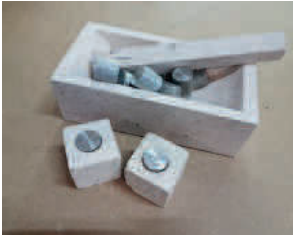
Preparación de probetas para ensayo de ataque con aluminio.
