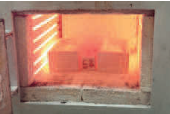
Ensayo de ataque con aluminio a 1000°C aproximadamente.
